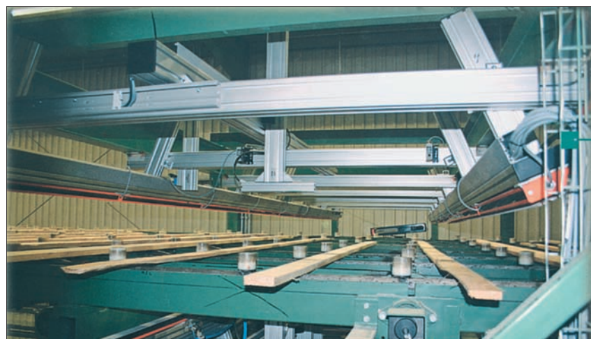
Bretter passieren den Waldkanten-Scanner und werden an der folgenden Trimmersäge je nach Ergebnis automatisch fertig gekappt.
