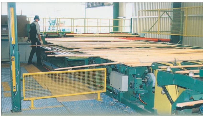
Beurteilungsstrecke am Anfang des Sortierwerks: Durch manuelles Vorziehen werden Bretter für die Vorkappung vorbereitet.
