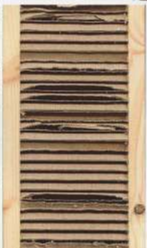
38 Die Materialkombination von dünnen Fichte- bzw. Douglasie-Deckschichten mit Wellstegeinlagen führt zu stabilen Sandwiches mit sehr geringen Rohdichten zwischen 170 und gar nur 110 kg/m 3 (Quelle: elka-Holzwerke, Lud. Kuntz GmbH)
